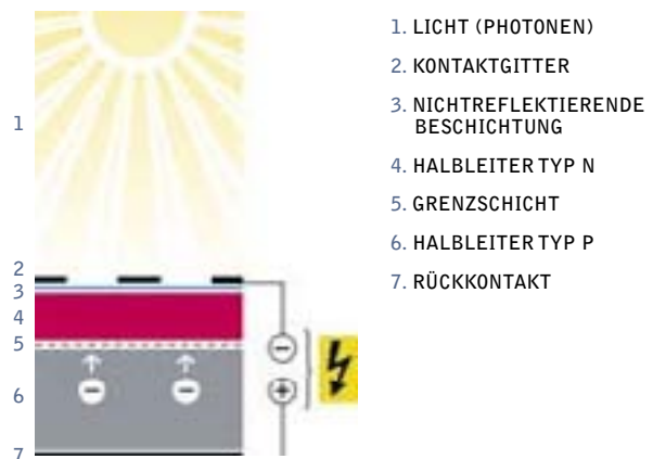
Abb. 31: Technologie der Photovoltaik
